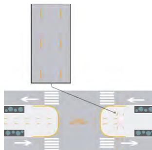
**IDENTIFICACIÓN DE INSTALACIONES SUBTERRÁNEAS:** Indica el trazo de las instalaciones subterráneas con objeto de evitar que, cuando se realicen trabajos de construcción de nuevas instalaciones o labores de mantenimiento, se llegue a afectar las ya existentes.
